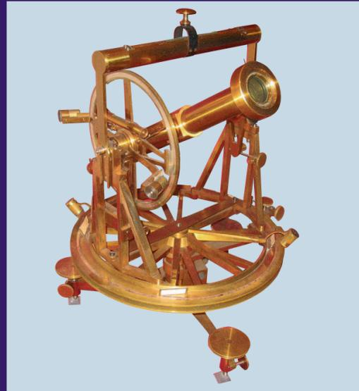
Instrument de mesure (théodolite) utilisé sur le terrain par les officiers norvégiens dans le Finnmark
