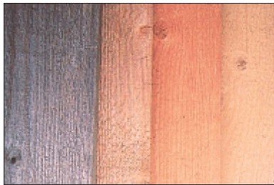
Naturlig inntoning av granpanel i Oslo-området. Panelet har stått eksponert for vær og vind i henholdsvis; 0, 4, 8 og 20 uker. Foto: Mycoteam.
