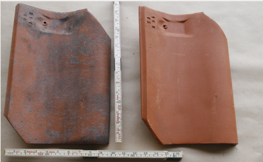
Ny enkeltkrum tegl uten fals. Til høyre en vanlig rød variant, til venstre en kunstig eldet stein, såkalt "engobert". Foto: Sjur Mehlum © Riksantikvaren
