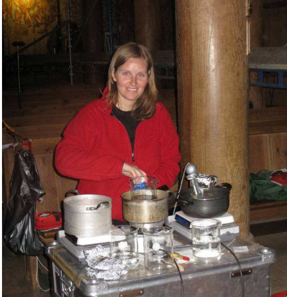
Fig. 19: Størlimet løses i vann og varmes opp til ca 45°. Foto: NIKU 2009.
