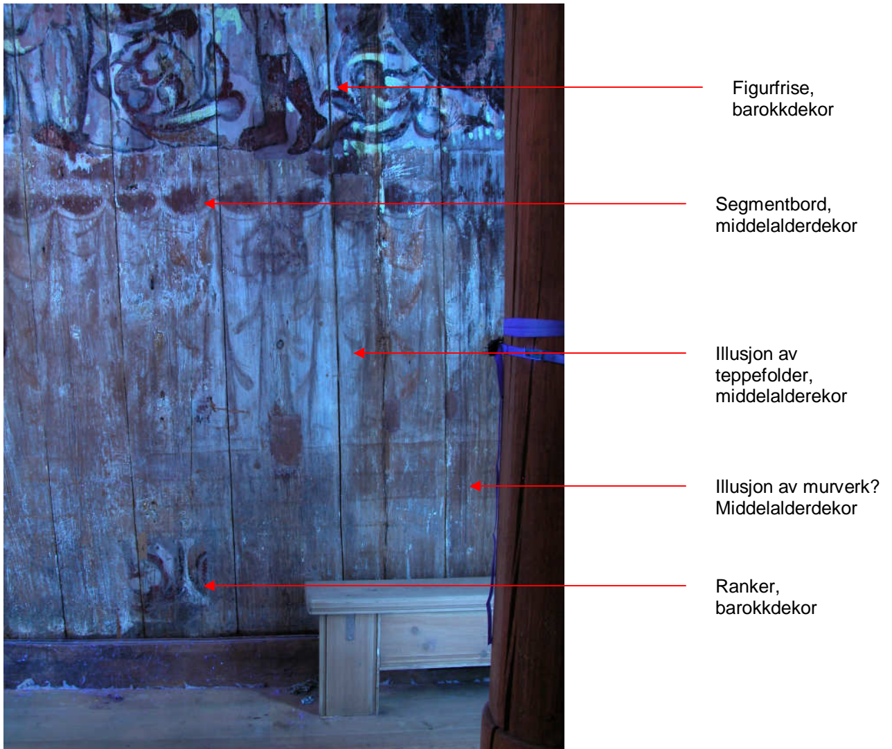
Fig. 5: Opptak av nedre del av nordvegg i koret i ultrafiolett belysning. Foto: NIKU 2007.
